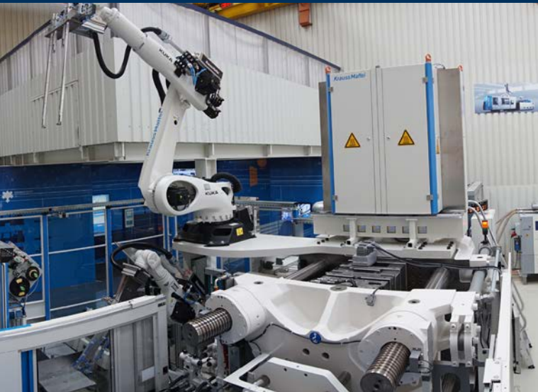
Automatisierte Produktionsanlage zur Herstellung von endlosfaserverstärkten Thermoplasten. Bild: KraussMaffei
