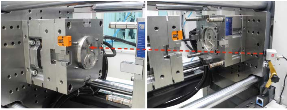
Abb. 1: Positionierung der Infrarotkamera im Werkzeug-Einbauraum
