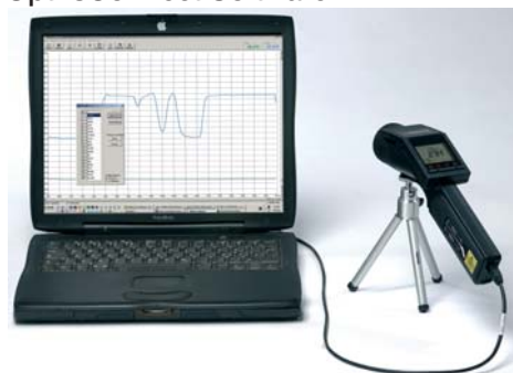
OptrisConnect Oszilloskop-Software für 20 Messwerte pro Sekunde
